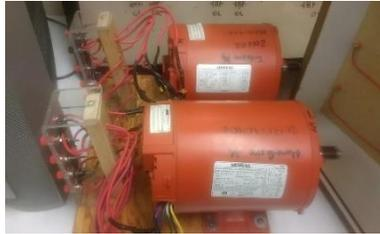
**FIGURA 11. MOTOR MONOFÁSICO**
