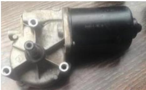
**FIGURA 8. MOTOR REDUCTOR.**
