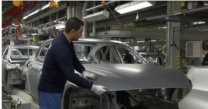
**FIGURA 12. PROCESO DE ENSAMBLE DE AUTOS.**
