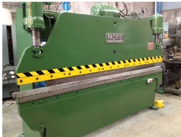
Figura 8. (Plegadora o dobladora de láminas y placas)
