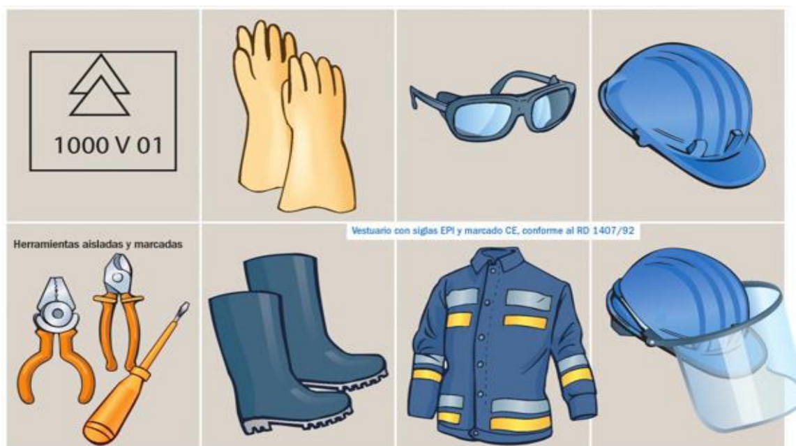
Figura 6 Equipo de Seguridad Electrico
