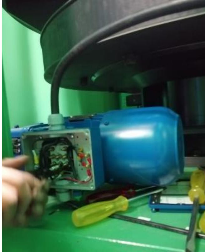
Figura 57 Motor trifásico 220v base giratoria maquina 1.
