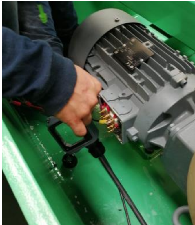
Figura 54 Conexión Trifásica 220v.
