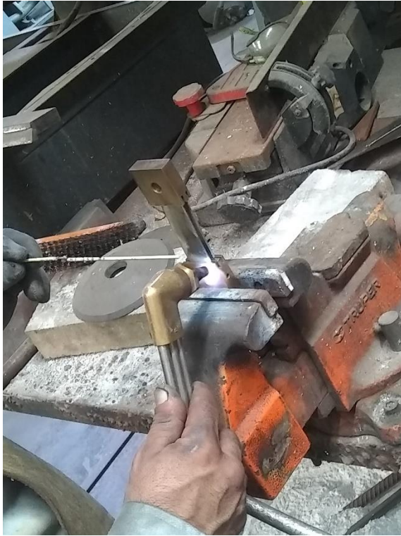
Fig 28. Soldadura de las piezas con plata piezas
