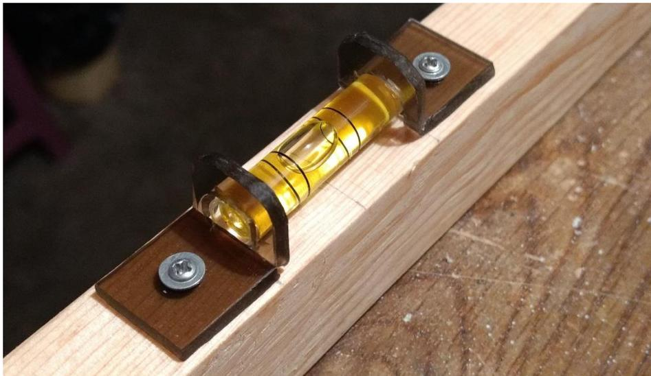
Figura 11.63. Nivel de burbuja atornillado a la estructura.
