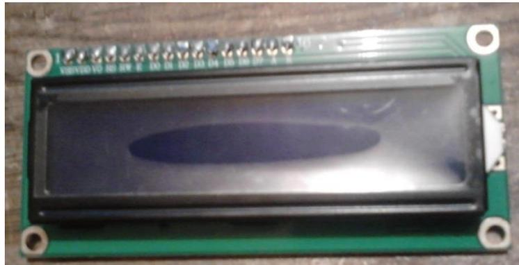
Figura 11.32. Display LCD (16x2).
