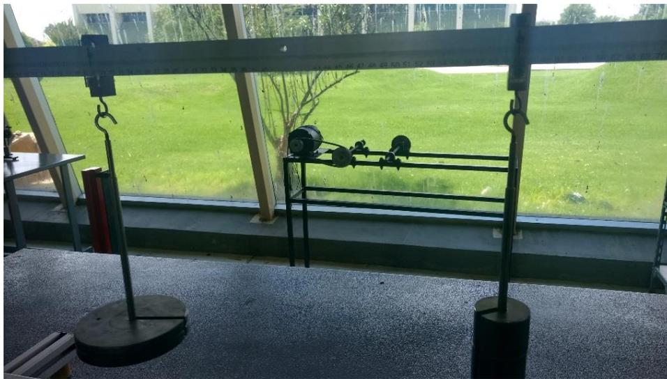
Figura 11.4. Regleta con fuerzas en distintos punto del marco para dinamómetros.
