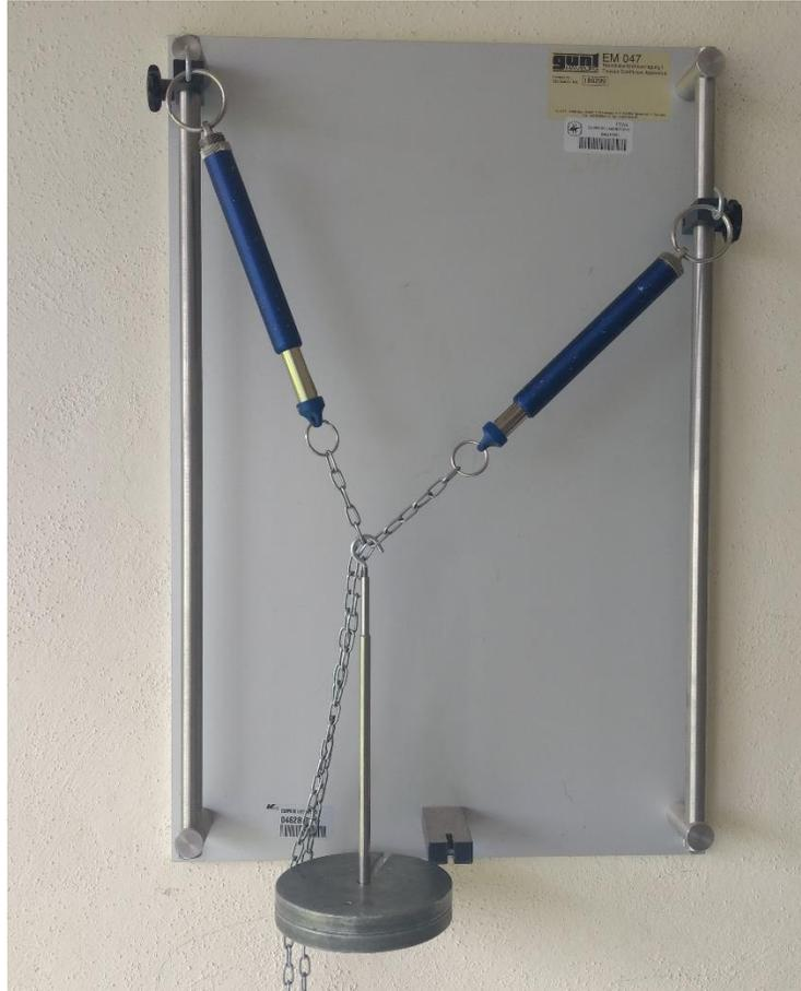
Figura 11.5. Estructura con dinamómetros para sumatoria de fuerzas.
