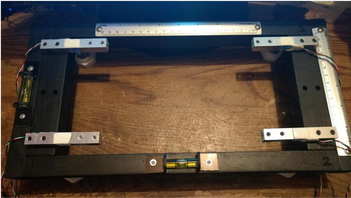
Figura 11.67. Estructura con todos los componentes colocados y pintada.
