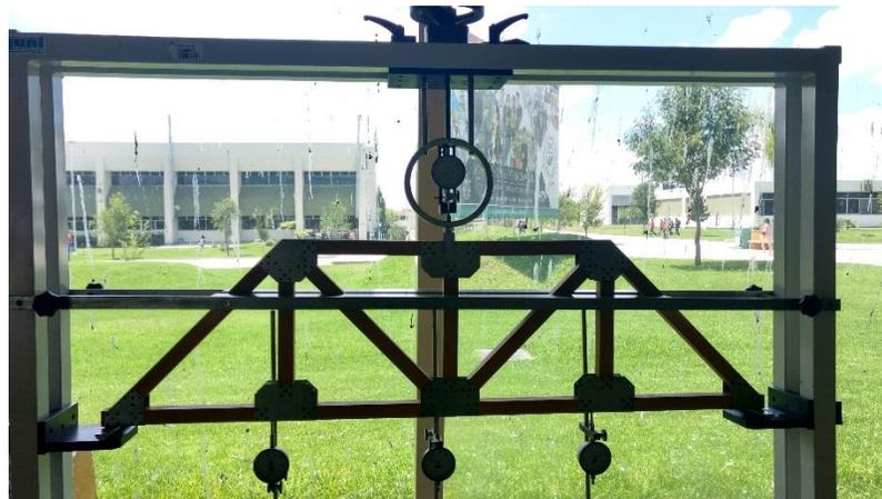
Figura 11.1. Estructura de puente con indicadores de deformación.
