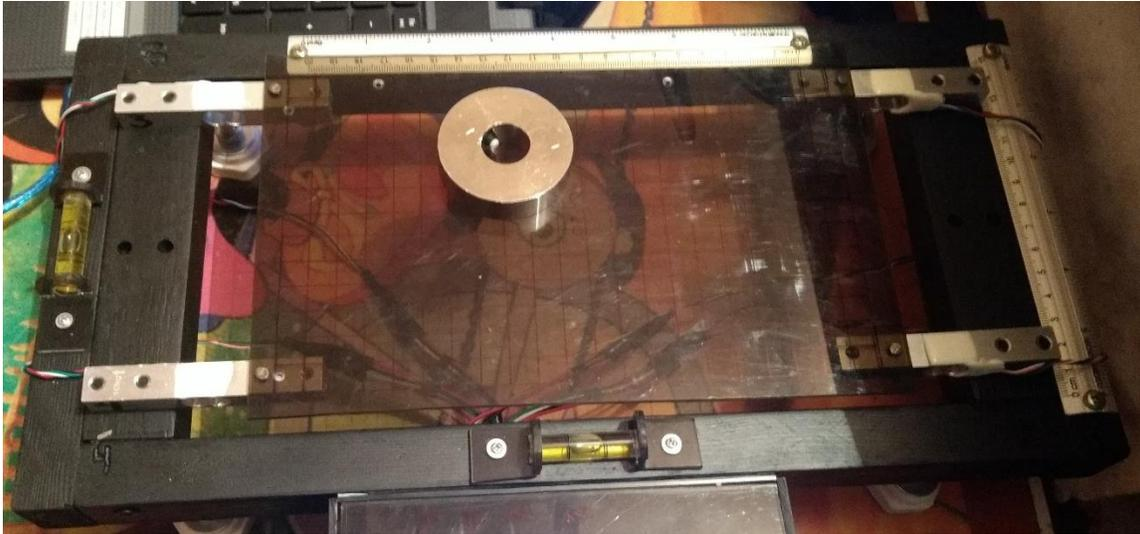
Figura 11.76. Prueba con una distancia de 8 cm y 4 cm con una fuerza de 2N.
