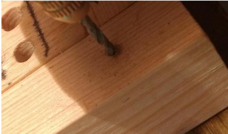
Figura 11.62. Barrenado de estructura para niveles de burbuja.
