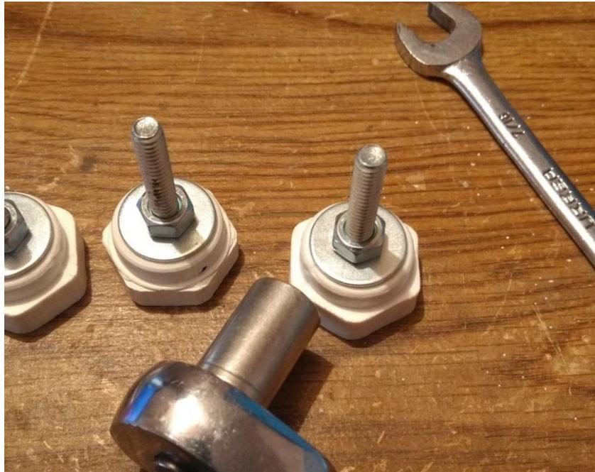
Figura 11.54. Apriete de turca y tornillo para obtén nivelador.
