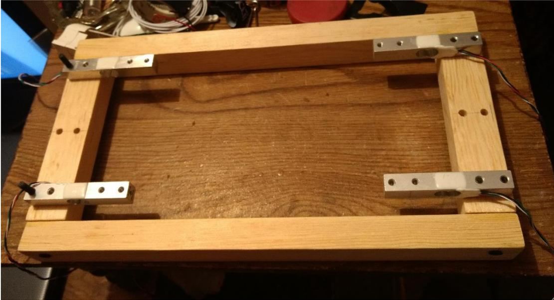
Figura 11.34. Sujeción de sensores en estructura.
