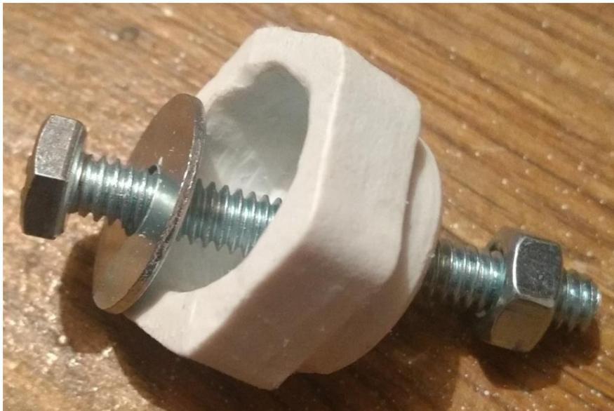
Figura 11.53. Colocación de tornillo, tuerca y rondana.
