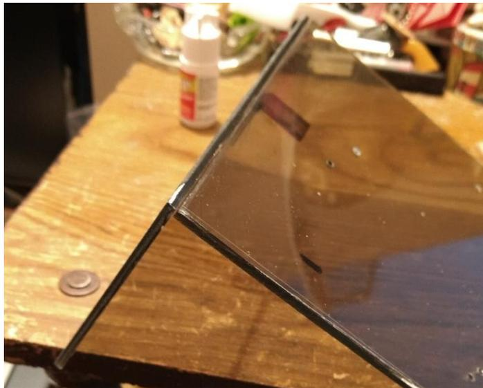
Figura 11.51. Acrílicos pegados para hacer caja de acrílico.
