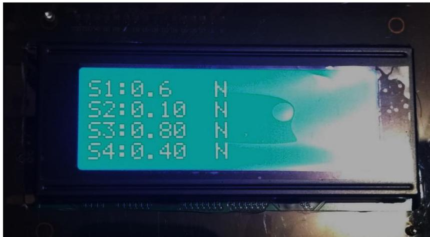
Figura 11.78. Resultados desplegados por la LCD con los sensores.
