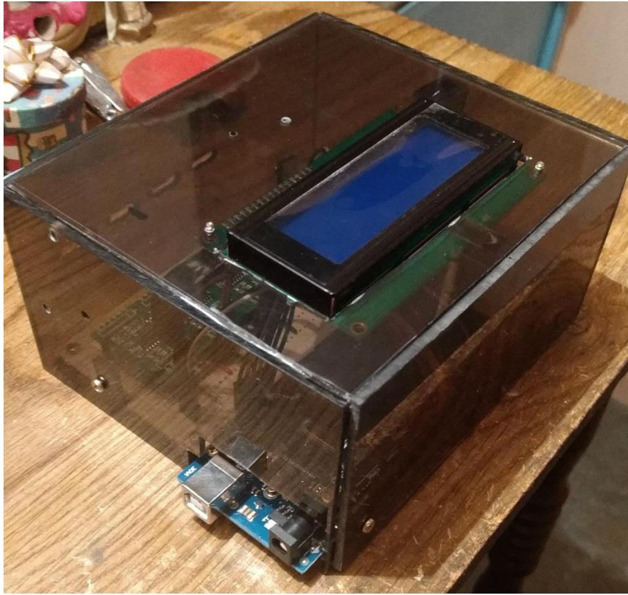
Figura 11.52. Caja de acrílico del circuito.
