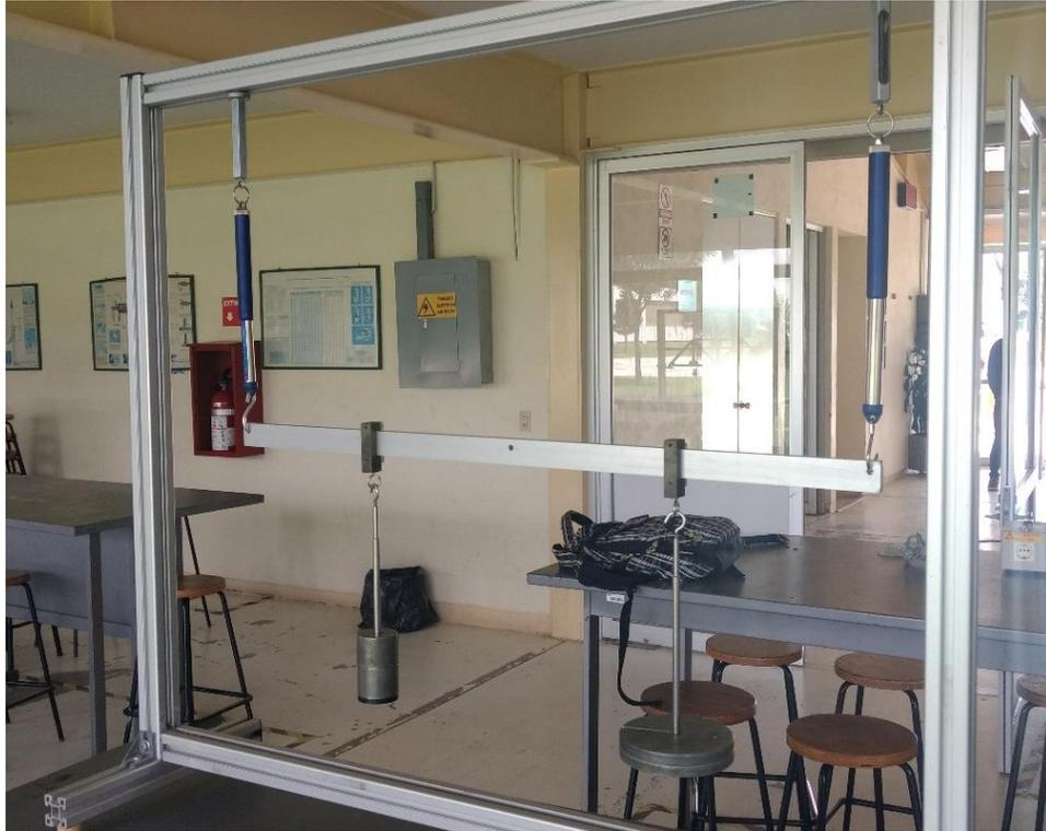
Figura 11.3. Marco para dinamómetros con diferentes puntos de fuerzas.
