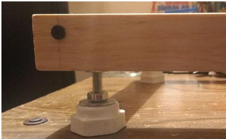
Figura 11.57. Niveladores colocados en la estructura.
