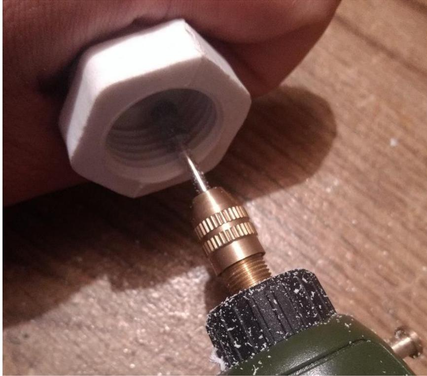
Figura 11.53. Desbaste de conexión de PVC para manguera.
