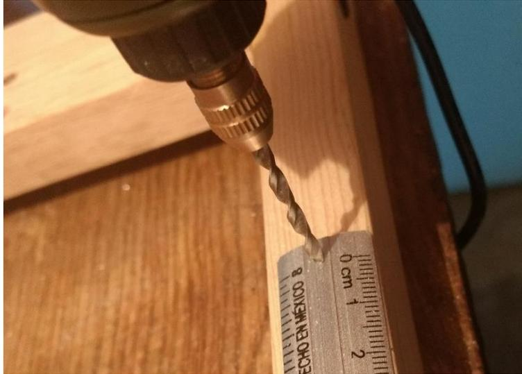
Figura 11.58. Barrenado de escalímetro y estructura.
