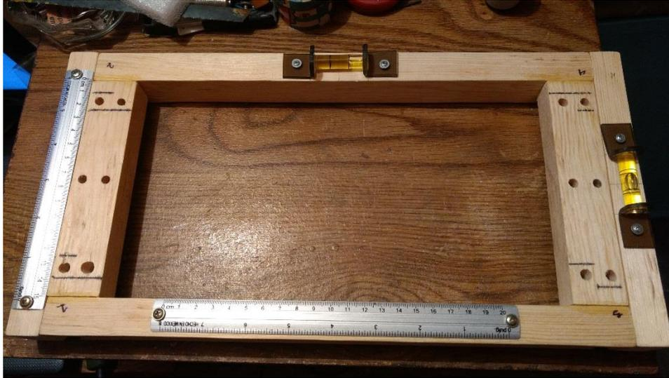
Figura 11.64. Estructura con los niveles y escalímetros.
