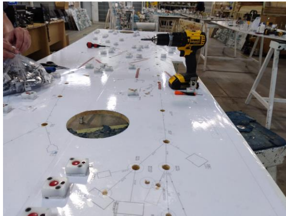
Figura 67. Preparación de tablero.
