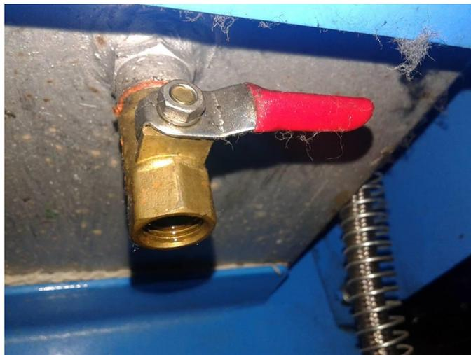
**Figura 30.** llave de paso para vaciado de aceite.
