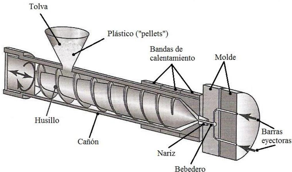
**Figura 1:** Estructura de la unidad de inyección. Adaptado de: Kalpakjian, S. Steven Schmid. 2008. Manufacturing Processes for Engineering Materials. 5ª ed. Prentice Hall.
