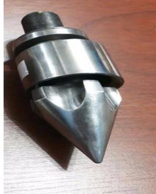
**Figura 28.** Punta Nueva para máquina Inyectora.
