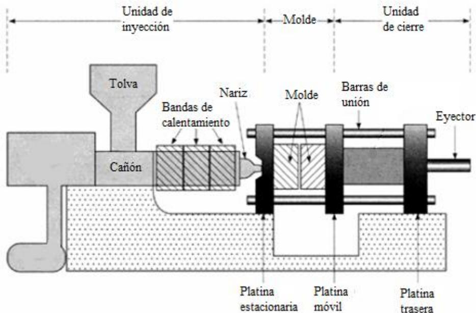
**Figura 2.** Estructura general de una inyectora de plástico.
