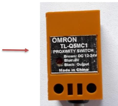
**Figura 13.** Sensor dañado.
