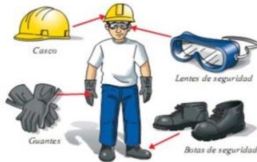
**Figura 19.** Equipo de seguridad.
