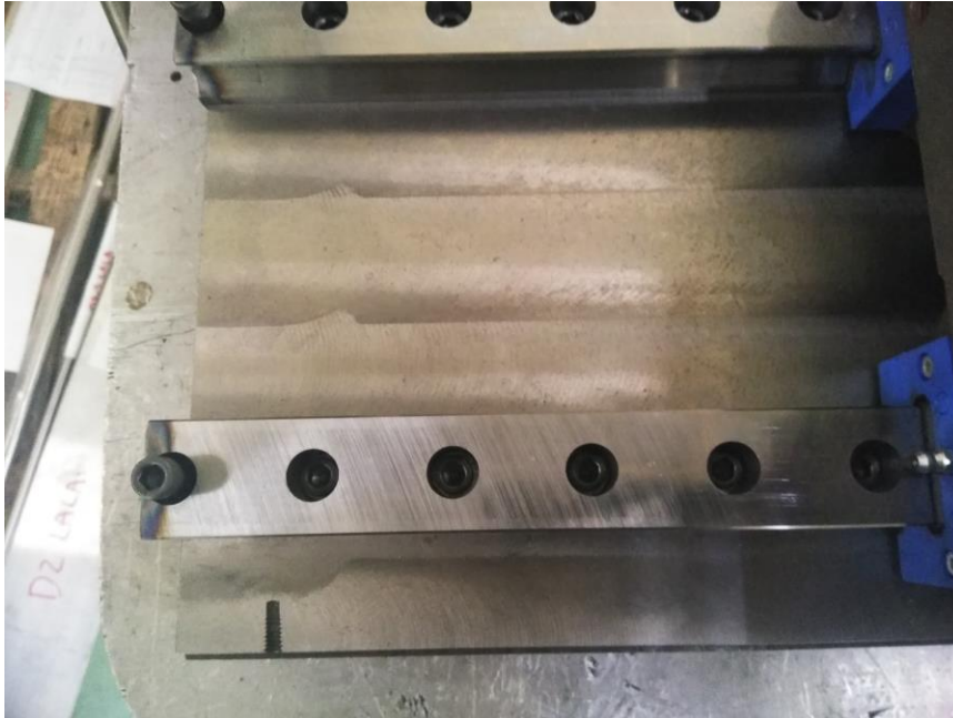
Figura 7. Sistema de correderas modificado guías lineales.
