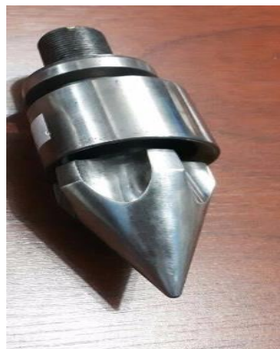
Figura 28. Punta Nueva para máquina Inyectora.
