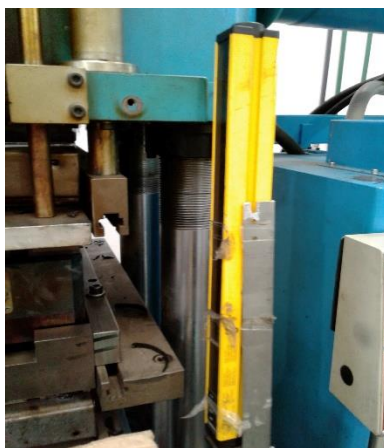
Figura 12. Barras fotoeléctricas nuevas.
