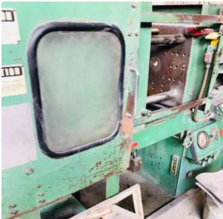
Fotografía 2. Máquina Inyectora de plástico. (Puerta de seguridad)
