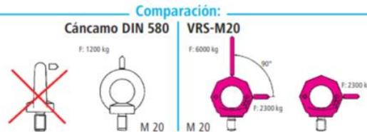
Esto es solo posible con el cáncamo RUD-VRS, ya que puede ser ajustado a la dirección de tiro estando totalmente enroscado. En el caso de tener que voltear a plena carga piezas como moldes, troqueles y/o matrices, recomendamos utilizar los modelos provistos de rodamientos de bolas, como el WBG o la colección PowerPoint.
