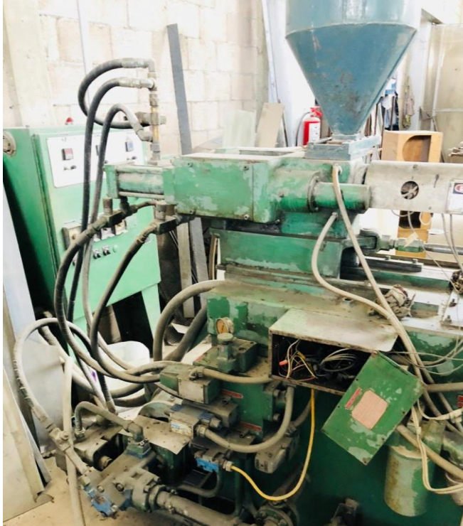
Fotografía 1: Máquina Inyectora de plástico. (Cañón y depósito).
