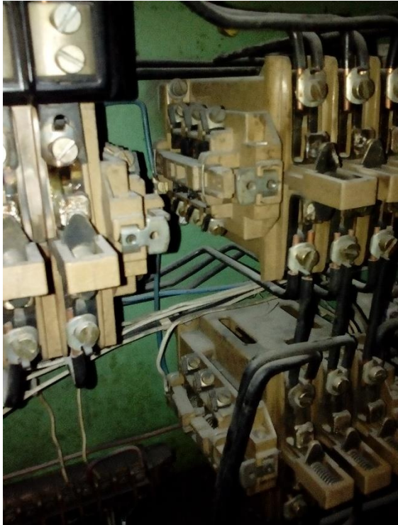
Fotografía 8: Máquina para realizar maquinados complejos. (Conexión Estrella-Delta)
