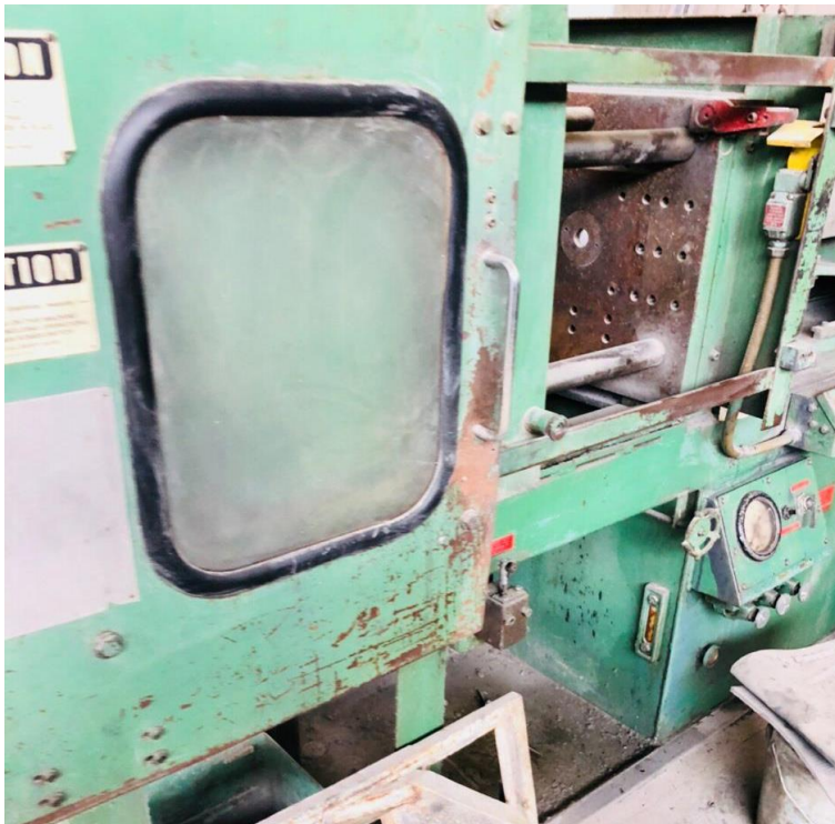
Fotografía 2: Máquina Inyectora de plástico. (Puerta de seguridad).
