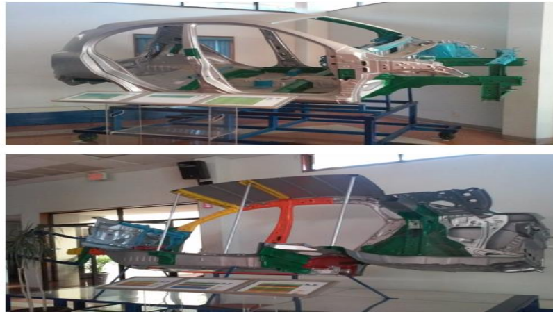
Ilustración 1.5 Componentes en carrocería y su nivel de soporte
