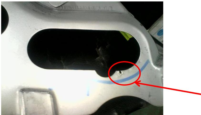
**Ilustración 33:** Defecto de fractura
