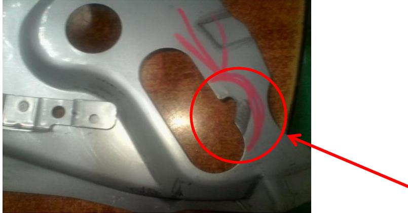
**Ilustración 38:** Defecto marca de scrap
