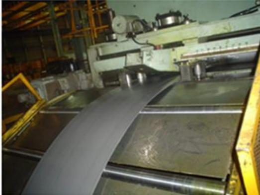
**Ilustración 42:** Alimentación de lámina al troquel
