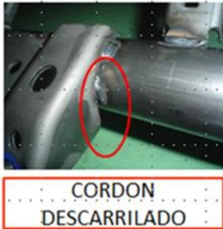
**Ilustración 40:** Defecto cordón descarrilado
