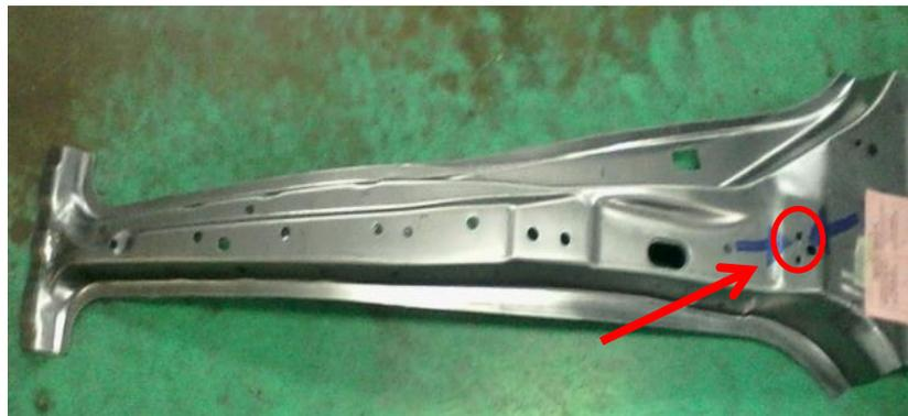
**Ilustración 44:** Defecto barreno demás
