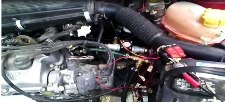
*Ilustración 59. Prototipo montado en el vehículo.*
