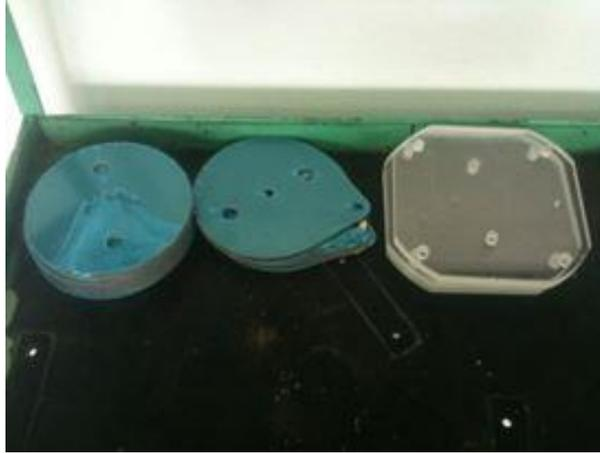
*Ilustración 37. Componentes de la celda generadora de hidrogeno.*
