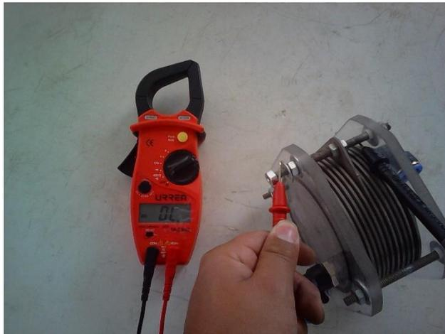
*Ilustración 41. Medición de resistencia y continuidad con multímetro.*
