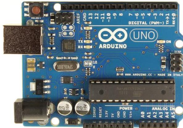
*Ilustración 26. Microcontrolador Arduino UNO. (UPTON, 2013)*
