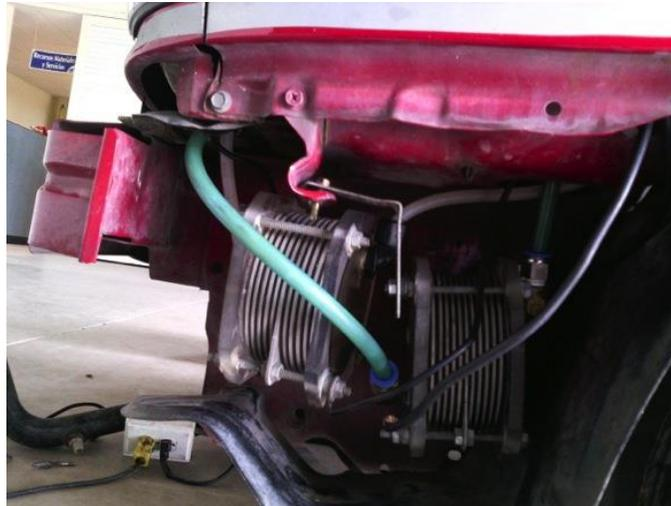
*Ilustración 62. Celdas de hidrogeno instaladas en el vehículo.*
