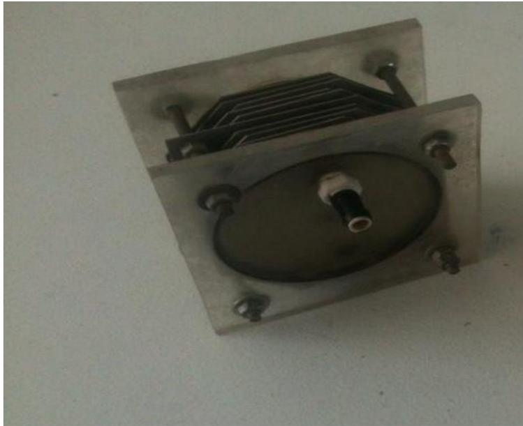
*Ilustración 27. Celda de hidrogeno a optimizar.*
