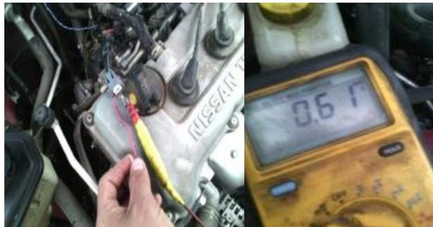
*Ilustración 50. Monitoreo en diferentes sensores de fuel injection.*
