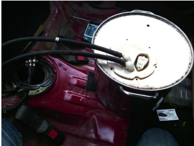
*Ilustración 61. Tanque auxiliar para las pruebas de recorrido de trayectorias.*
