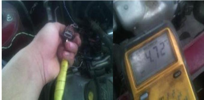
*Ilustración 49. Monitoreo en diferentes sensores de fuel injection (TPS).*
