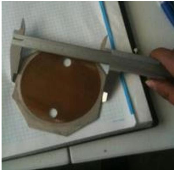
*Ilustración 28. Medición del componente electrodo de acero inoxidable.*
