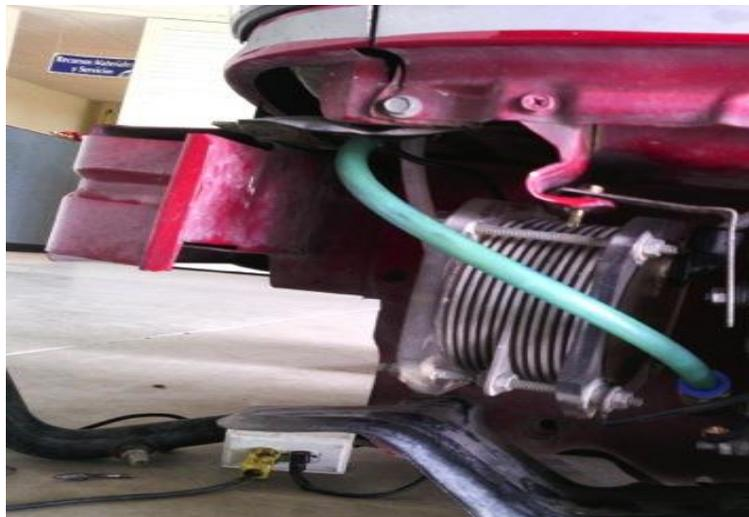
*Ilustración 47. Celda de hidrogeno instalada en el interior del vehículo.*
