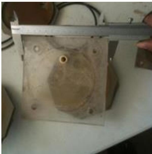
*Ilustración 29. Medición del componente de tapa de acrílico.*
