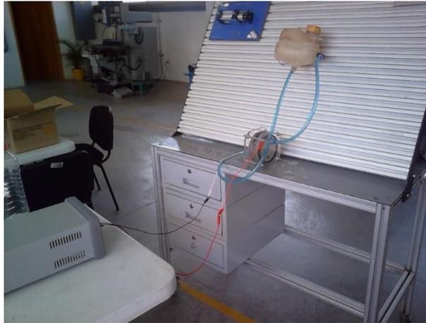
*Ilustración 42. Conexión de alimentación a la celda de generación de hidrógeno.*
