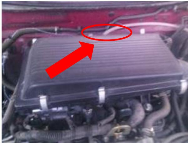
*Ilustración 48. Generación de hidrógeno instalada en el ducto del filtro del aire.*
