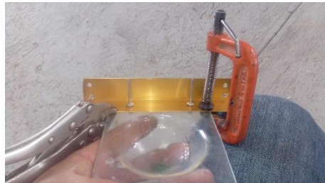
Fig. 21 ángulo que ira sujeto a los cangilones para sostener la pala
