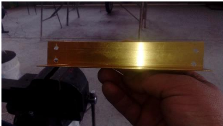
Fig. 21 ángulo que ira sujeto a los cangilones para sostener la pala
