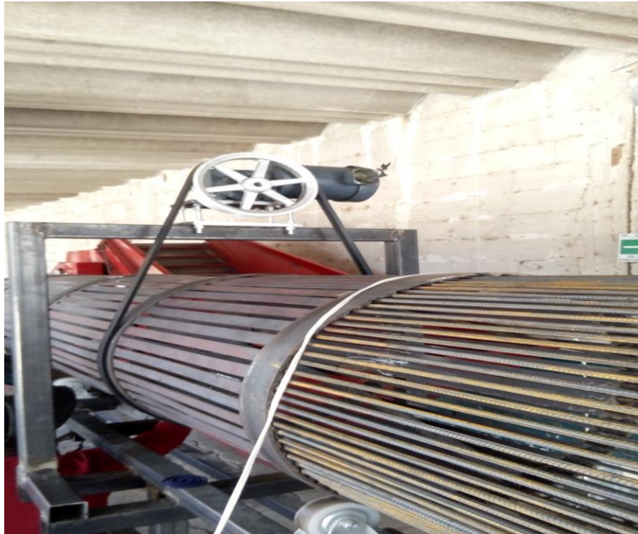
Fig. 9 Montaje de bandas “v”
