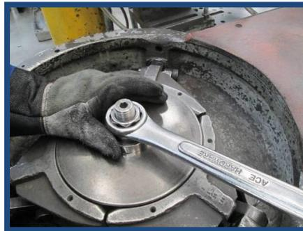
Fig. 14 Ajuste de la tuerca para cerrar el mandril
