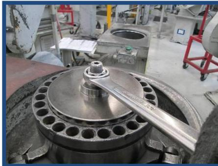
Fig. 17 Retirado de espaciador
