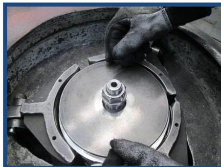
Fig. 12 Colocación de los anillos a las zapatas
