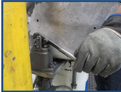
Fig. 16 Accionamiento de la válvula para que suba la flecha
