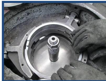
Fig. 11 Colocación de anillos a la zapata
