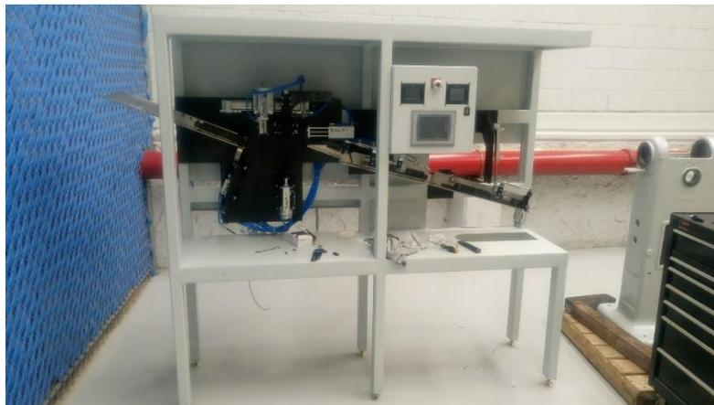
Fig. 7 Máquina de Inspección de Anillos
