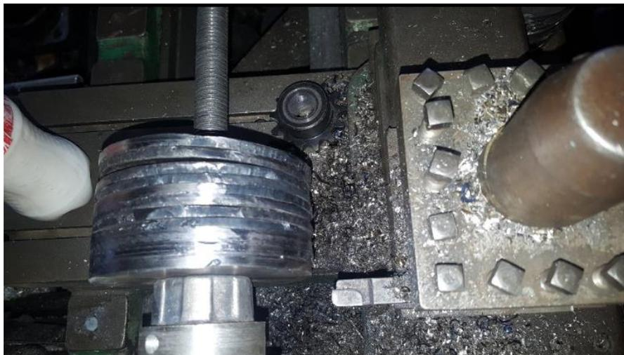
Figura 54. Desbaste en torno de las tapas
