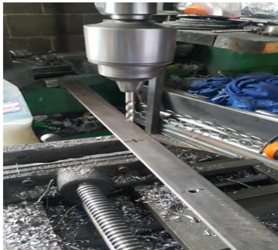
Figura 37. Barrenado a varios puntos al ángulo
