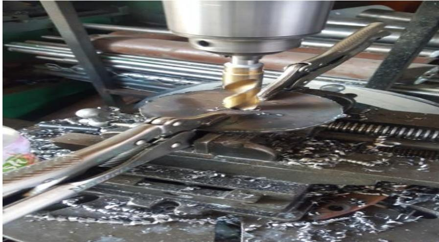
Figura 53. Barrenado de tapa
