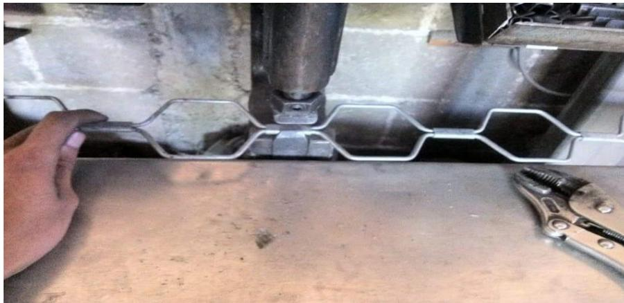
Figura 48. Unión de alambre con dobladora
