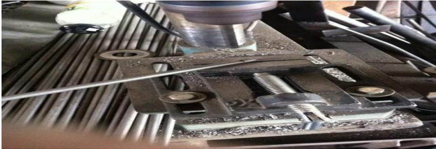
Figura 60. Barrenado de flecha
