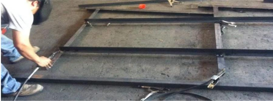
**Figura 38. Estructura lateral lista para soldar**
