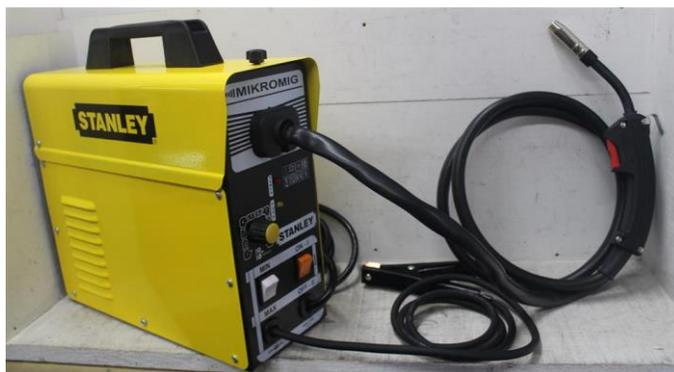
Figura 34. Soldadura de Micro Alambre
