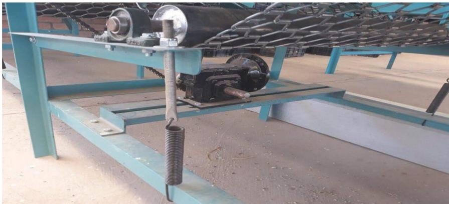
Figura 76. Posicionamiento de Motor y transmisión
