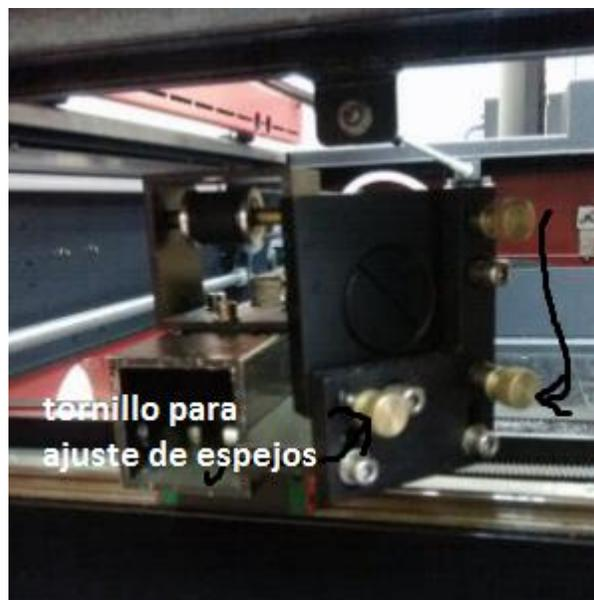
imagen 10 tornillos para el ajuste de los espejos
