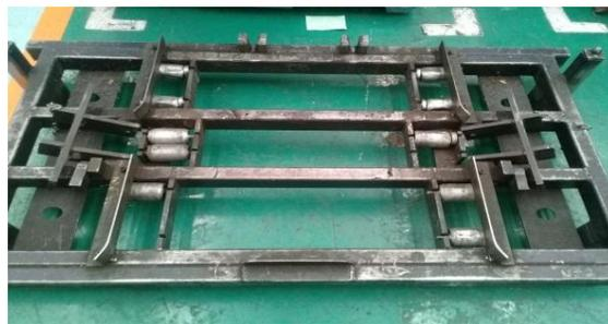
**Figura 28.** Bases donde se coloca el magazine.
