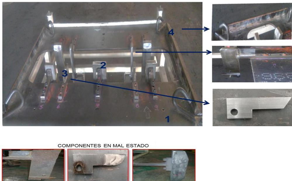
**Figura 11.** Especificaciones de mejora en Placa Flotante 55511 1EL000Y: (1) placa flotante, (2) magneto, (3) tope con uña, (4) viga.
