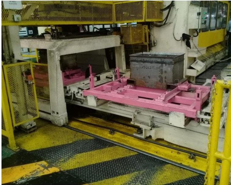
**Figura 13.** *Presentación final de Sistema de clampado de base general en producción normal.*
