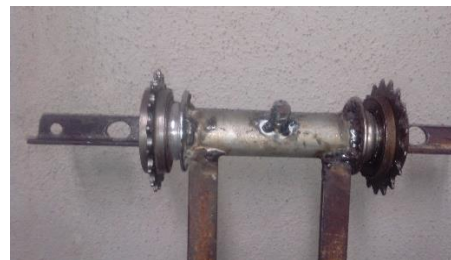
Fig. 16 Estrellas inferiores y superiores donde ira colocada la cadena con cangilones.
