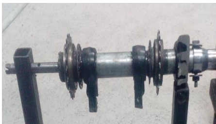
Fig. 16 Estrellas inferiores y superiores donde ira colocada la cadena con cangilones.
