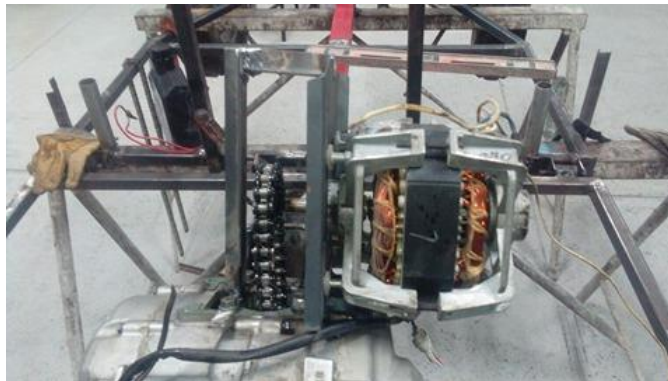
Figura 6 Adaptación de transmisión con motor eléctrico
