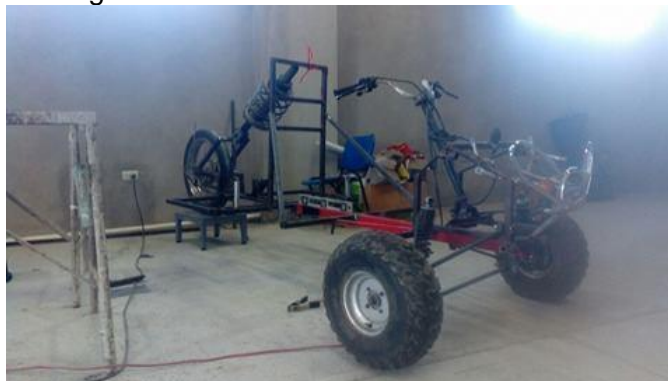
Figura 7.vehiculo con aramazon terminada
