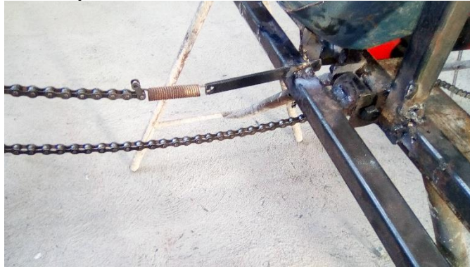
Figura 8. Sujeción de cadena con resorte en la base trasera
