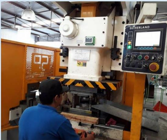
Figura 2.- Revisión manual de un troquel para detección de una posible falla de punzonado.
