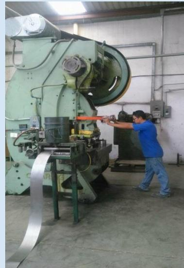
Figura 7.- Finalmente a la terminación del mantenimiento se montó el troquel para realizar comprobaciones de corrección de la falla.
