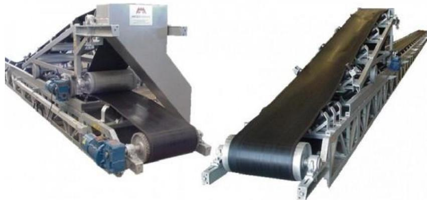
Figura 14.- Tripper móvil de una banda transportadora.
