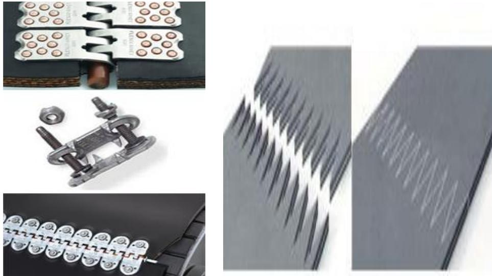
Figura 22.- Unión por grapas y vulcanizado.
