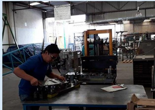
Figura 3.- Revisión detallada de todos los componentes del troquel una vez desmontado.
