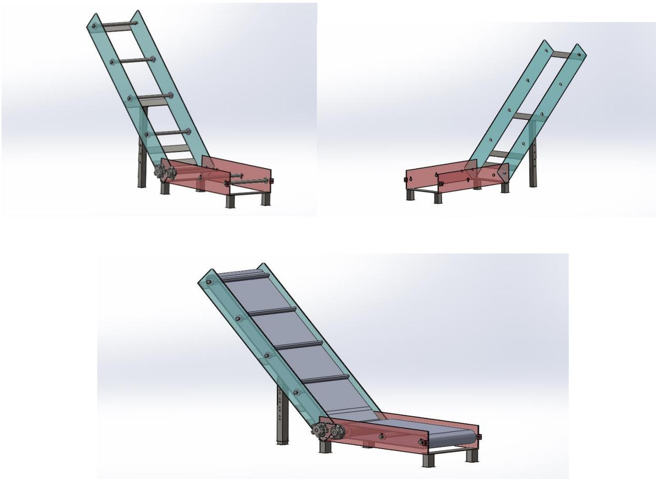
Figura 36.- Diseño banda transportadora estructura terminada para someterla a simulación estática.
