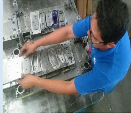
Figura 5.- Comprobación de falla ubicada en la última pieza producida.
