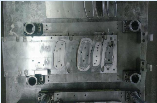
Figura 6.- Corrección de la falla detectada, cambio de punzonado y afilado de matrices de corte, para continuar con el armado.
