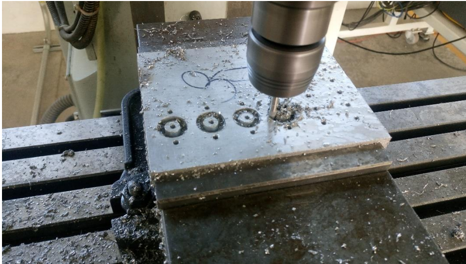
Figura. 20 maquinado de las cajas para los baleros en las fresadoras.
