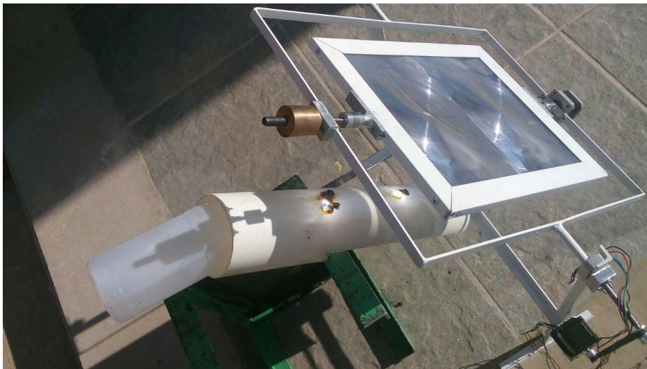
Figura 25. cuando el plástico o PVC llega a su punto de fusión y empieza el trabajo de la lente Fresnel.
