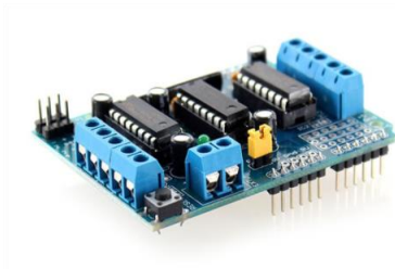
Figura.11. Shield para control de motores L293D
