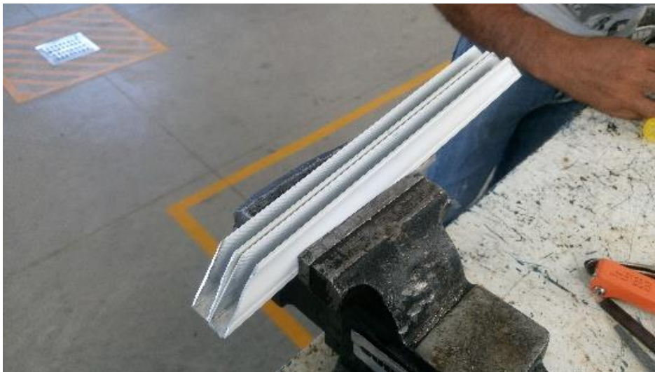
Figura. 19 corte y barrenado de los materiales para realizar los diferentes marcos de nuestro seguidor solar.
