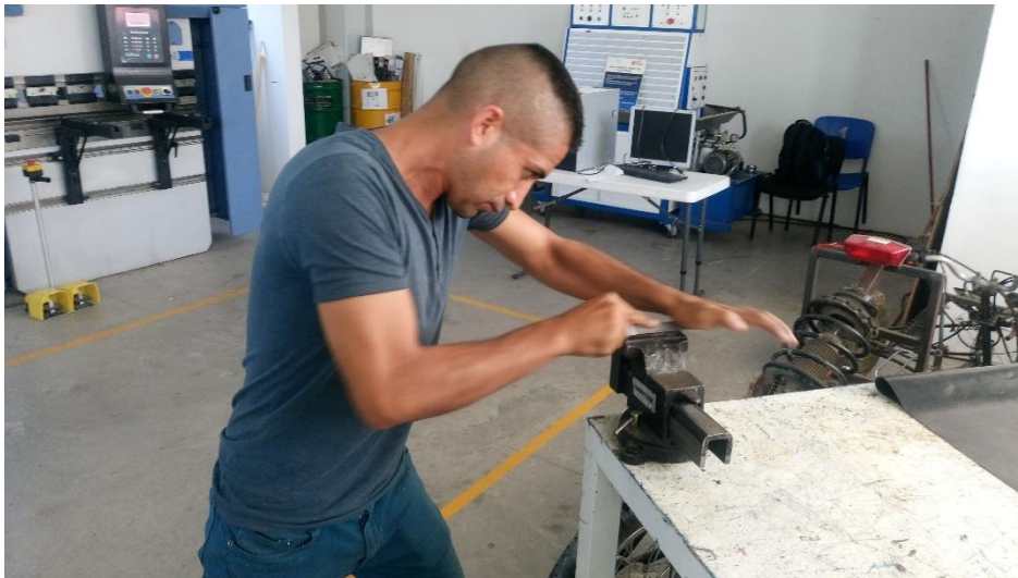
Figura. 21 lijado de las cajas de baleros para que el acabado sea el adecuado, o que esté libre de impurezas.
