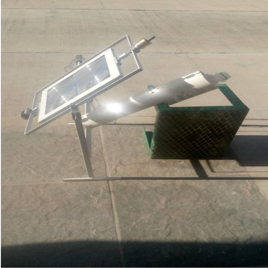
Figura 24. Focalización bien definida del punto de la lente Fresnel así nuestro objetivo.
