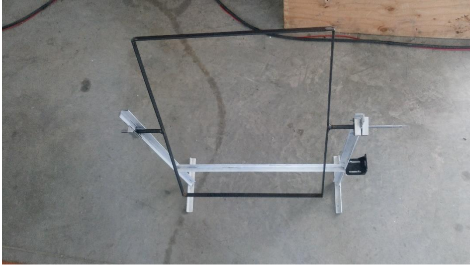
Figura. 22 ensamble del primer marco en la base fija de nuestro seguidor y de los baleros.
