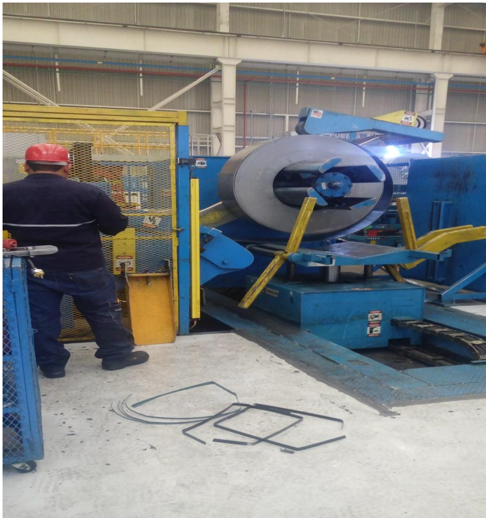
Fig. 9 Muestra al operador titular de la prensa configurando el avance y la velocidad de la bobina.
