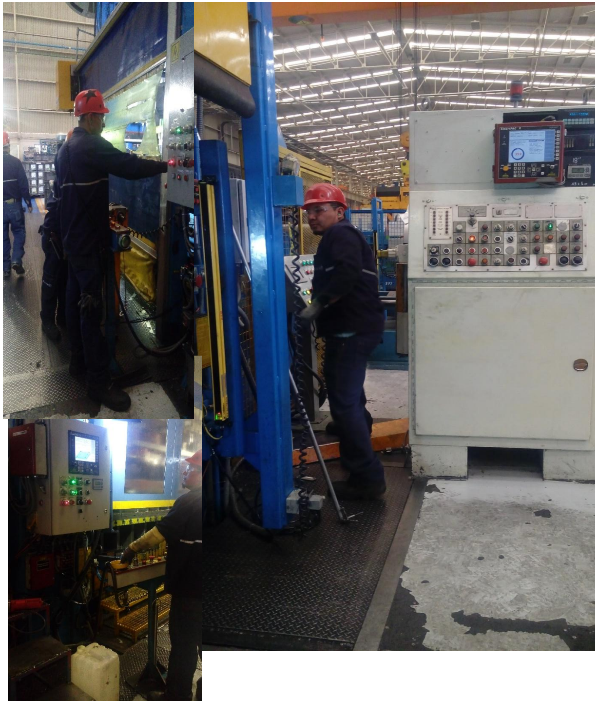
Fig. 10. Fue necesario realizar todos los ajustes a la prensa de manera minuciosa y de forma manual para lograr obtener los parámetros más adecuados con los cuales la prensa funciona de mejor manera y produciendo partes de gran calidad.
