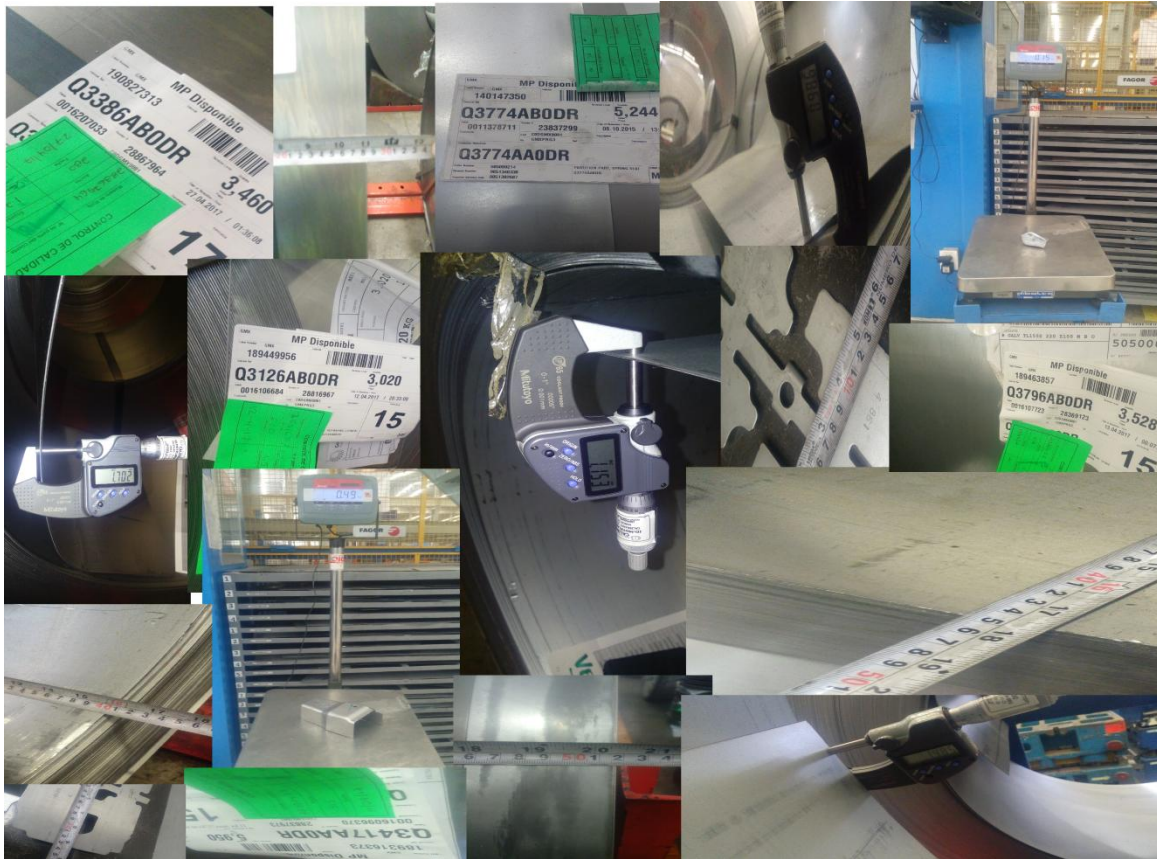
Fig. 7 Dimensionado y comprobación en físico de las bobinas (ancho y espesor).
