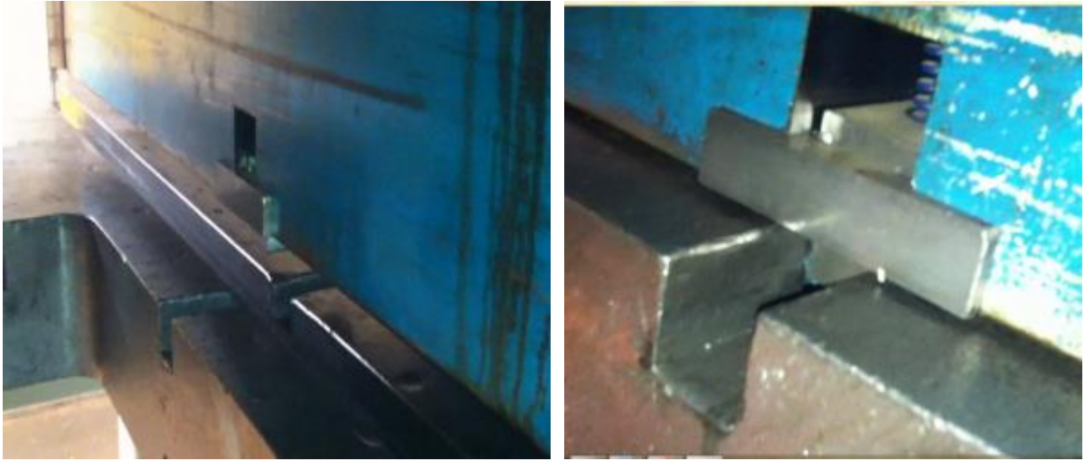
Figura 77.- Validacion del centrador en el troquel
