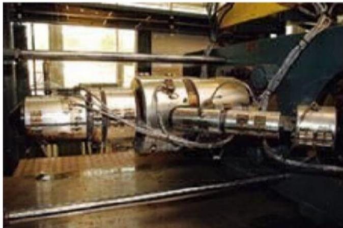
Figura 2. Máquina de co-inyección (PROCESO SÁNDWICH)
