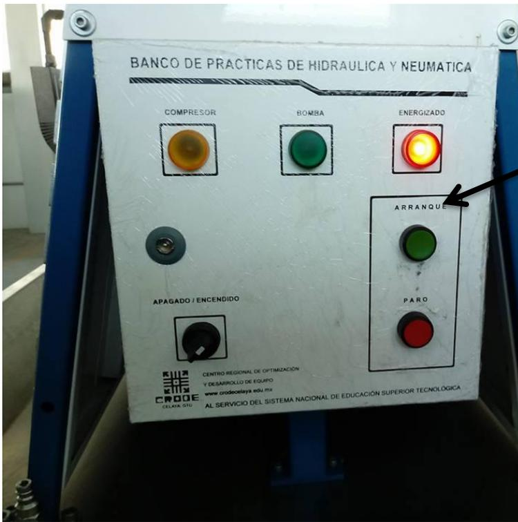
Botón de encendido de la bomba hidráulica
