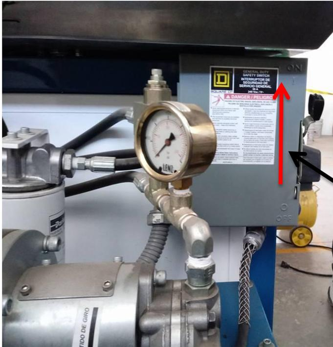
Esta palanca debe ser posicionada en el **I** o en **ON** para poder dar paso a la corriente
