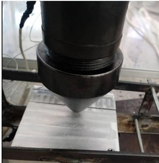
Figura 9. Cono o boquilla de inyección
