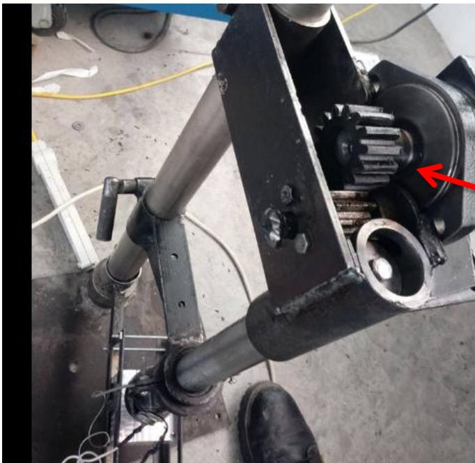
En esta imagen se aprecia el piñón (engrane), se detiene al llegar al final de su recorrido para entonces detener el giro del motor ya que está regulado con una válvula estranguladora
