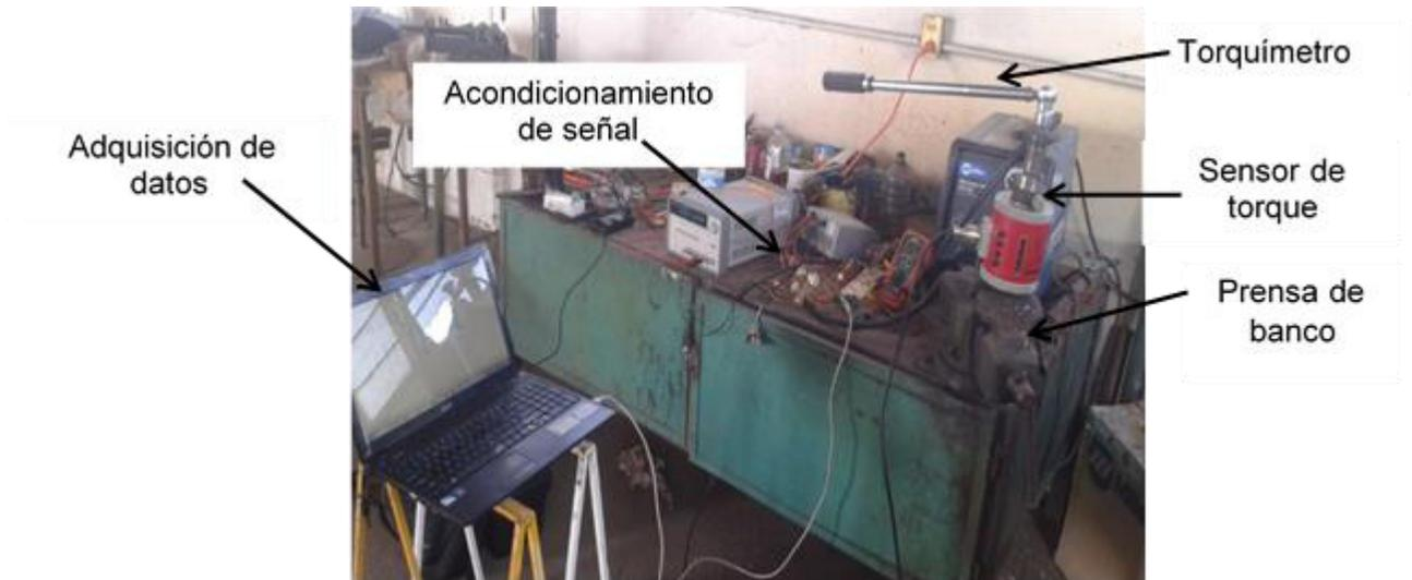
Figura 25. Calibración del sensor de torque.
