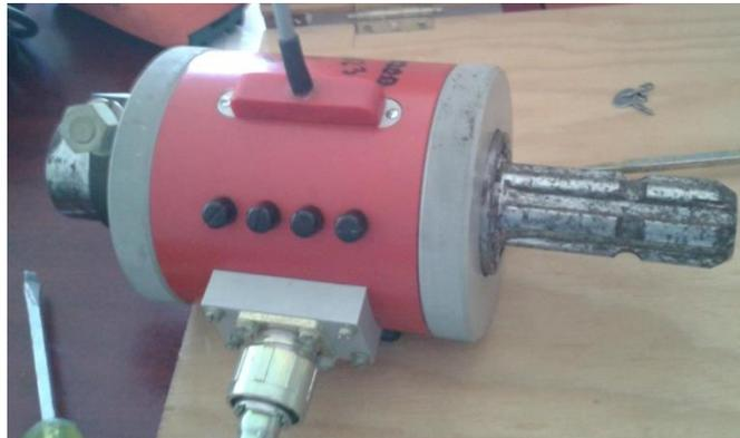
Figura 16. Transductor de torque.
