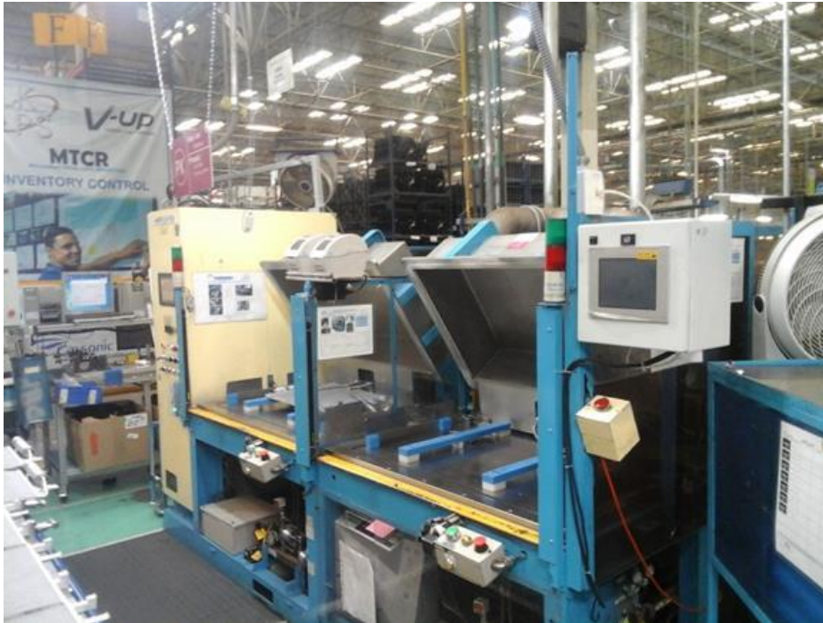
Figura 26.- Prueba de fuga o Leak Tester
