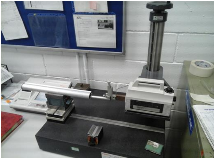
Figura 24.- Medición de tanque liquido con rugosímetro
