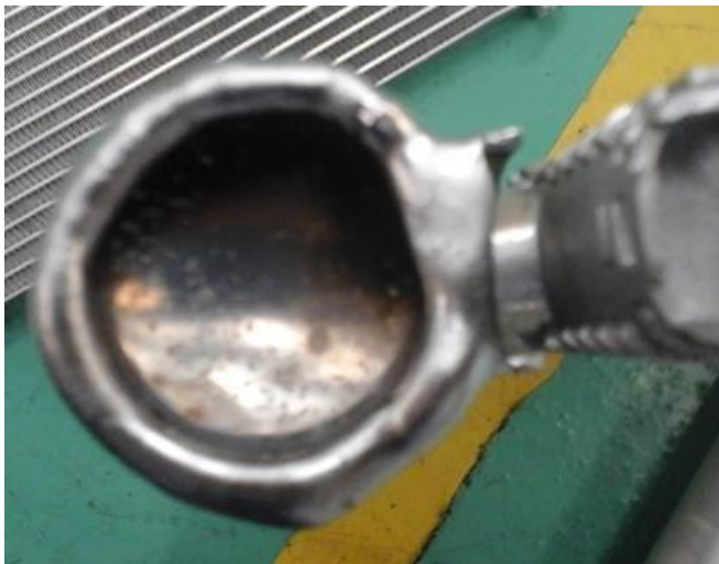
Figura 21.- Soldadura de CAP upr.
