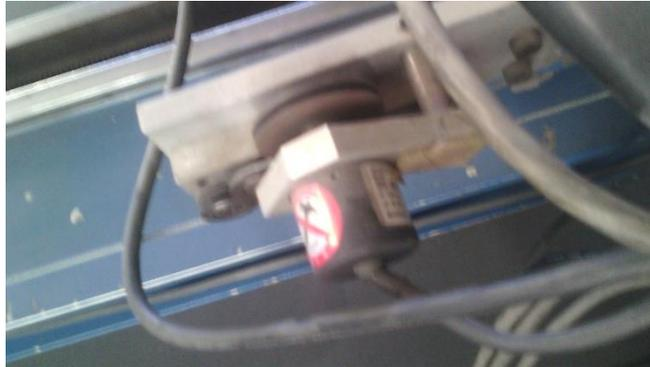
*Figura 9 encoder de la cortadora*
