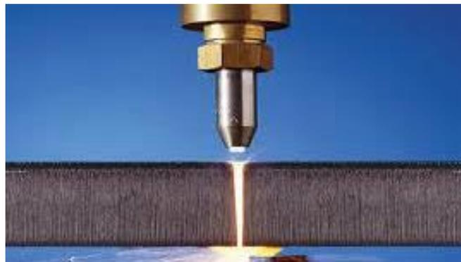
Figura 7. Cabezal de cortadora laser
