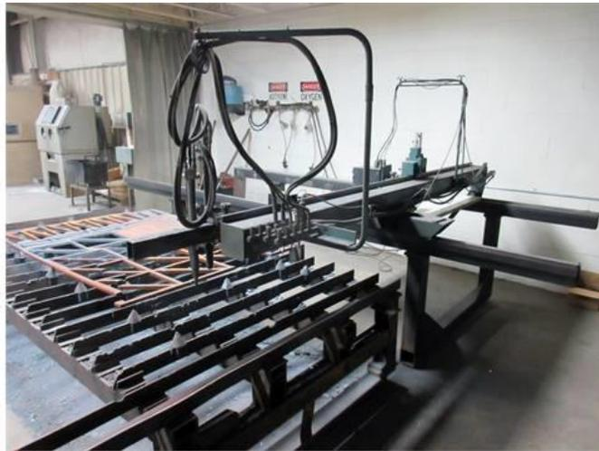
*Figura 23. Máquina cortadora por oxicorte 1*
