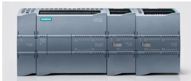
Figura 6.2. PLC Siemens
