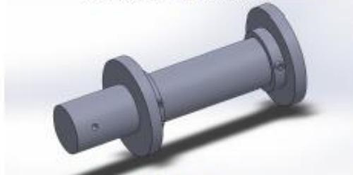
Figure 7. Eje adaptado para ejes chicos
