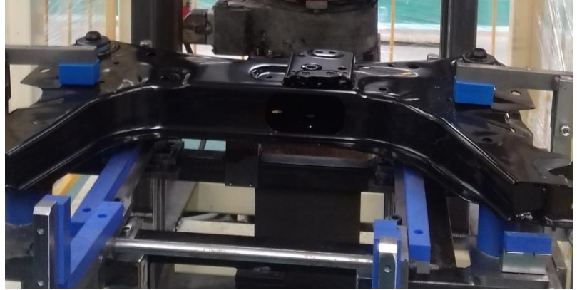
Ilustración 22: revisión de pieza en jig (posicionamiento)
