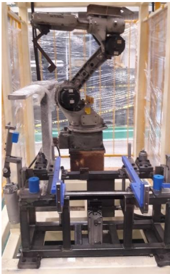
Ilustración 311: inicio de armado de jig
