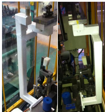
Ilustración 459: soportes para evitar vibraciones
