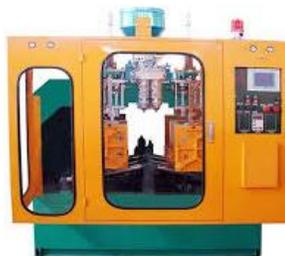
Fig. 1 Máquina de soplado
