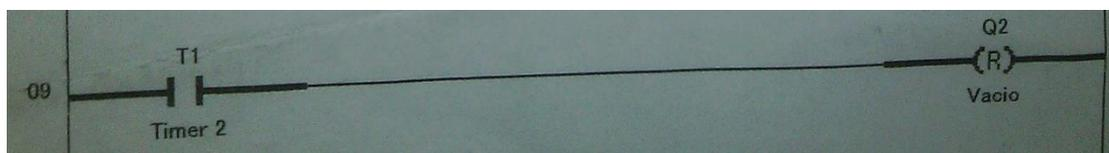
Fig. 21 Bomba de vacío desactivada
