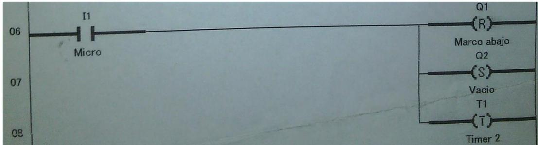
Fig. 18 Limit switch y bomba de vacío activados
