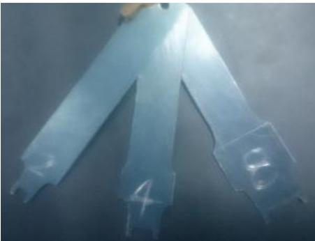
Ilustración 10. Laines para 2, 4 y 8 cables.
