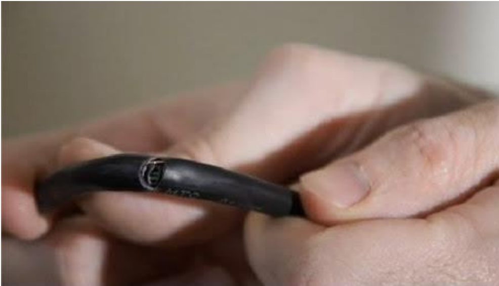
Ilustración 38: Detección de Cable RJ-45 Dañado
