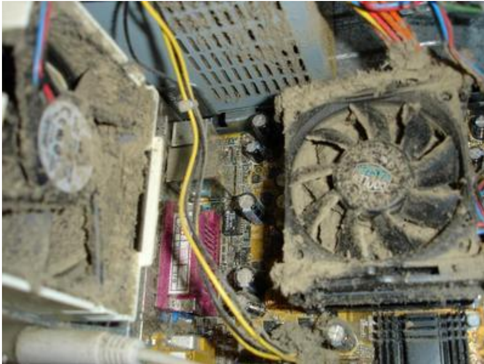
Ilustración 40: Limpieza interna de CPU
