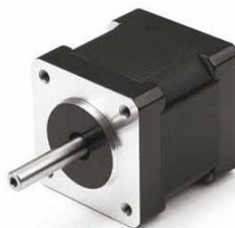
Los motores paso a paso se utilizan para la construcción de mecanismos en donde se requiere movimientos muy precisos. La principal característica de estos es el hecho de poder manipularlos a un paso o la vez por cada pulso aplicado. Este movimiento puede ser variable desde 90° hasta movimientos de 1.8°, es decir, que se necesitarán 4 pasos en el primer caso (90°) y 200 para el segundo caso (1.8°), para completar un giro completo de 360°.
