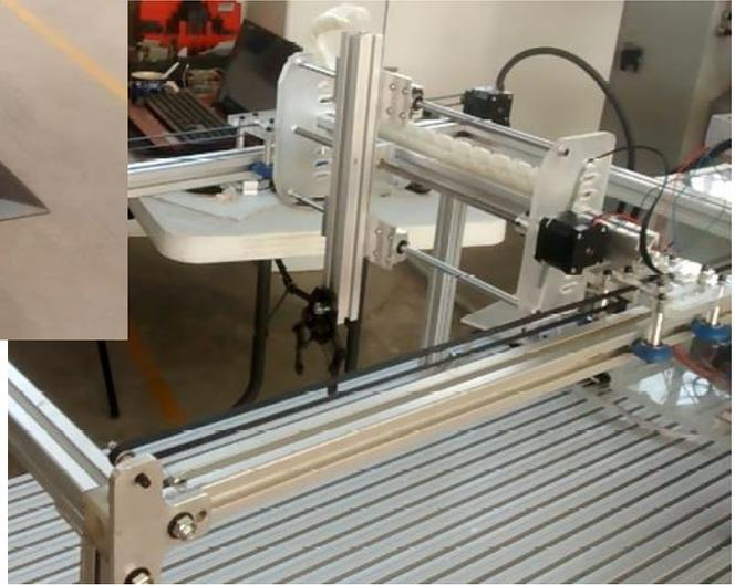
Detalle robot Gantry Terminado
