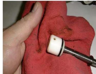
**⚠️ 19.-** Limpiar internamente dentro del tubo de carga con un trapo limpio y checar que no quede dentro ningún tipo de escoria o pelusas del mismo trapo.
