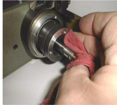
6.- Instale el front end del cabezal (utilice la llave de nariz o bien con la llave allen 3 mm).
