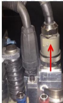
**!** 9.- Limpie la parte delantera de la pistola de la cabeza (pinza, sonda estabilizador, el receptor, punta del pistón, etc.) con un trapo y cepillo de alambre limpio y seco para eliminar la escoria y residuos de soldadura.
