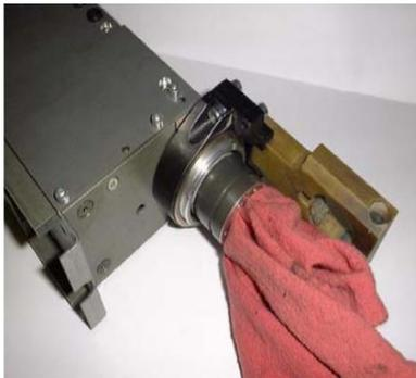
**⚠️ 20.-** Cuidadosamente remueva el O-Ring y chéquelo de que no esté dañado, que no esté roto o mal gastado y de ser así reemplazarlo.
