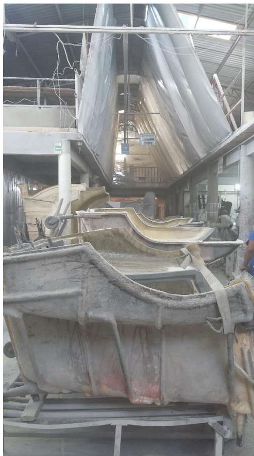
Figura 3.2.1. En esta imagen se muestra claramente como el área de laminado es abierta dejando así contaminación en todo lugar.
