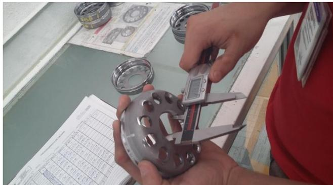
**Ilustración 9.- Medición de Diámetro Interno**
