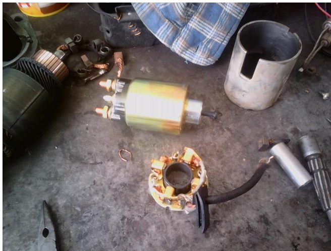
Figura 41. Piezas dañadas que se reemplazaron
