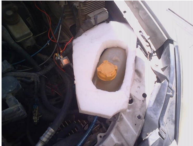
Figura 33. Moldes propuestos para la sujeción de depósito de agua
