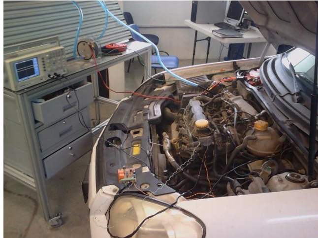
Figura 47 Pruebas de funcionamiento eléctrico de tarjeta PCB
