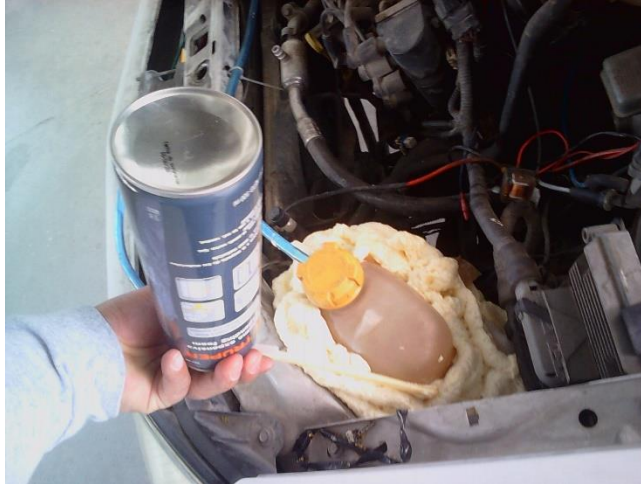
Figura 43 Fabricación del molde para depósito de agua.
