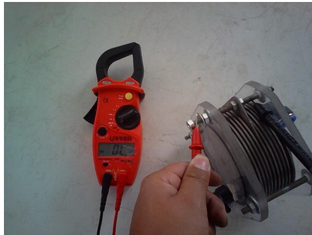
Figura 35. Medición de resistencia eléctrica
