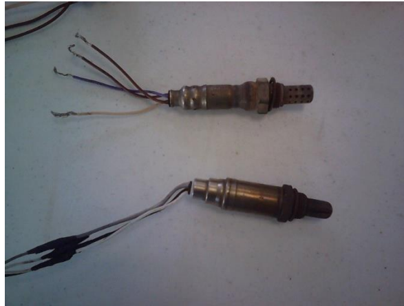
Figura 49 Sensores de oxígeno (superior dañado)
