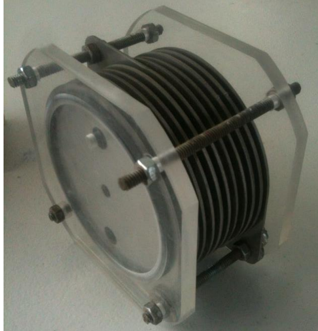
Figura 27. Celda armada con piezas modificadas en su diseño.
