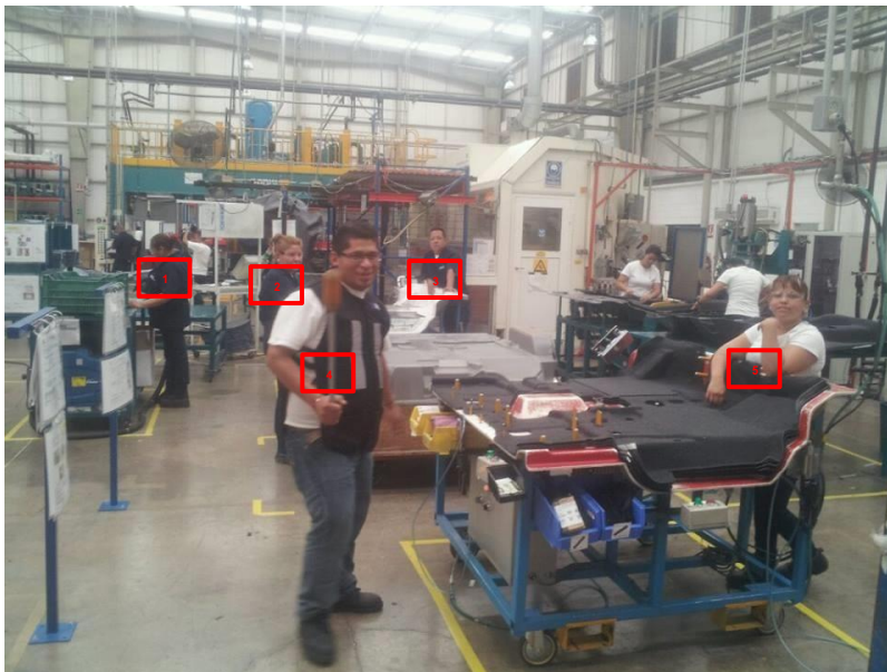
Fig 13. Imagen donde se muestra el nuevo número de posiciones en el proceso de ensamble de TPO en la línea 1
