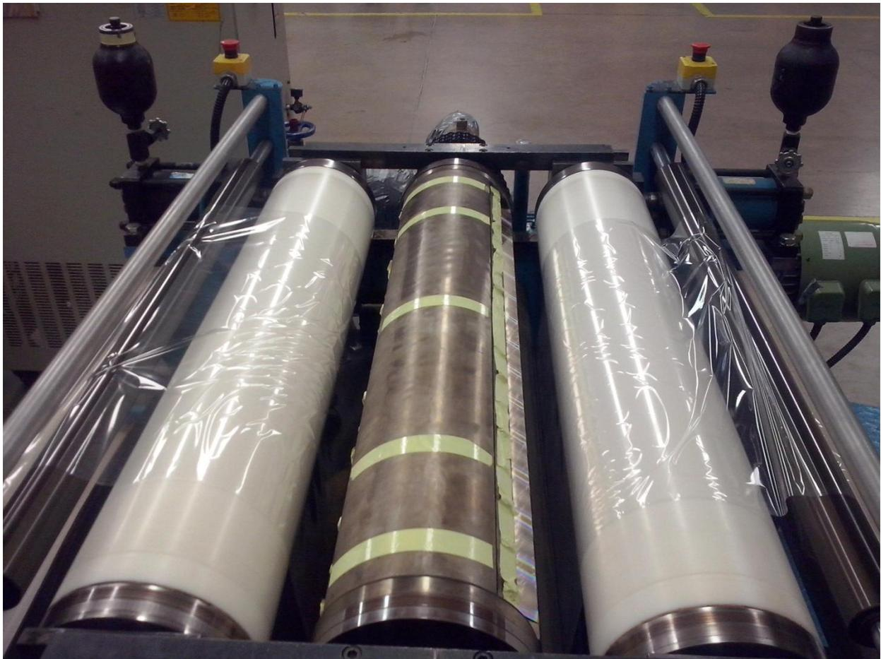
Fig. 22 Rodillos PR (Laterales) y Rodillo PR (Central), Embozadora
