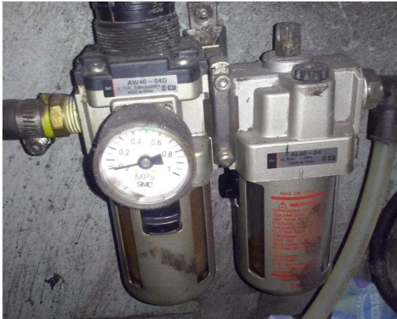
Fig. 18 Limpieza de Filtros de la Laminadora
