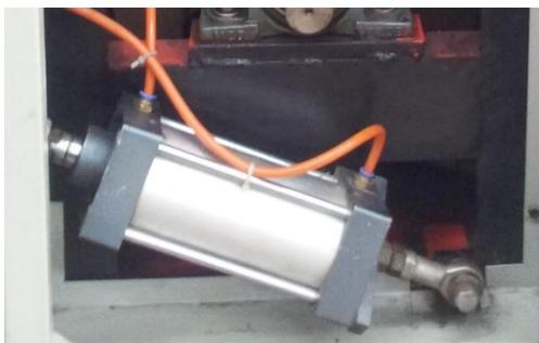
*Figura 5. Cilindro neumático.*
