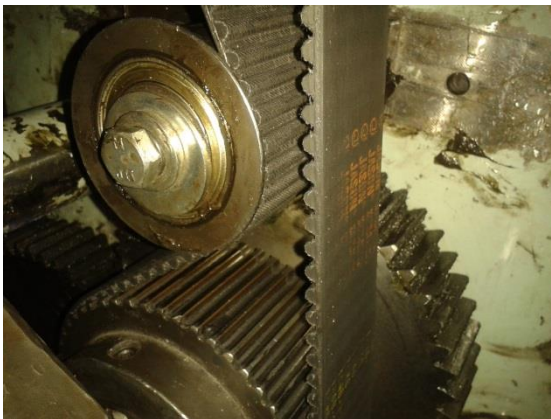
Fig.3.11: Engranajes dañados de la máquina cortadora de cartón. Fig.3.12: Engranajes reemplazados de la máquina cortadora de cartón.
