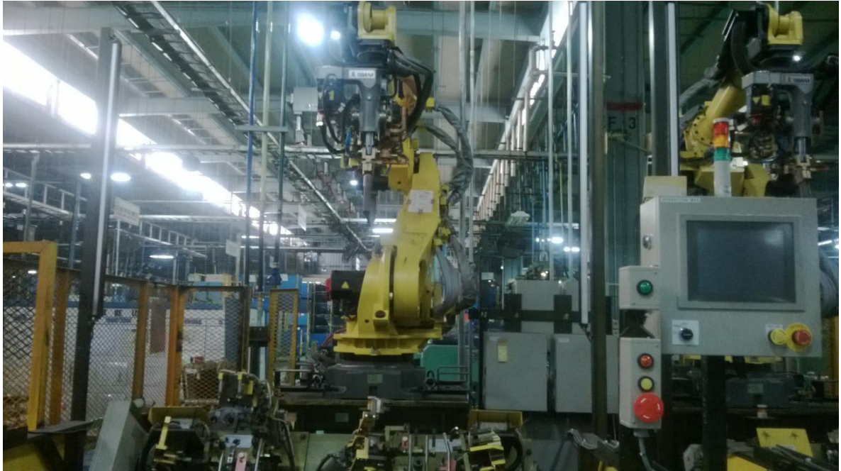
Figura 5. Robot Fanuc serie R-2000iB en Unipres Mexicana S. A. de C. V
