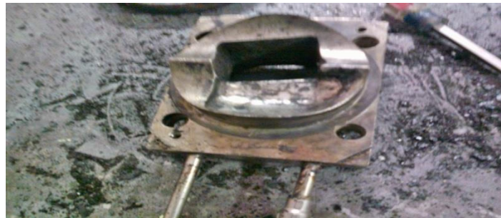
Figura 50.- Mantenimiento correctivo a bateas línea F, la función que realizan es la de vacío para que el material salga hueco, están colocadas en la parte del extrusor que trabaja a 240°
