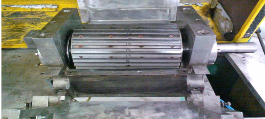
Figura 51.- Calibración de chumaceras, colocadas en motor navajas de aire. La función es cortar los hilos de resina aproximado a 3milímetros.
