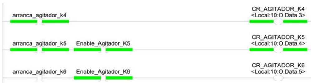
Figura 56.- Programación en RSLOGIX5000, muestra las variables agregadas al programa para todas las líneas, indicadas como. Enable_Agitador_K5 y K6.
