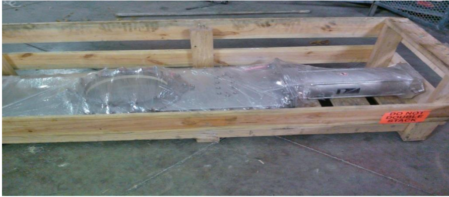
Figura 52.- Mantenimiento preventivo a válvulas vortex, realizan la función de abrir y cerrar paso a los materiales para llenado de tolvas de recibo.
