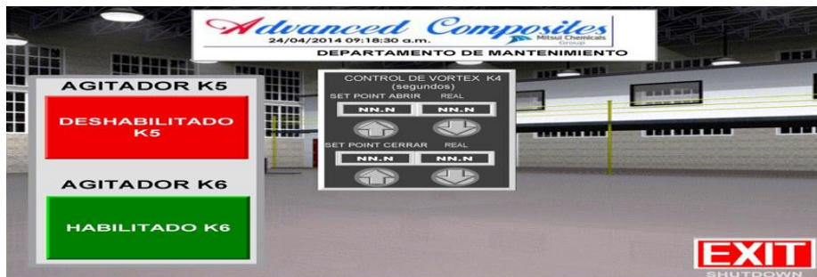
Figura 55.- programación en RSLOGIX500 y PANTALLA FACTORY TALK VIEW STUDIO, se realizó un programa actual para todas las líneas el cual consta de un botón de ON-OFF para los motores agitadores K4, K5 Y K6. Esta pantalla muestra como los operarios la observan del tablero de control de auxiliares.
