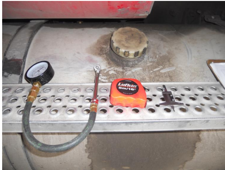
Fig. 3 Herramientas utilizadas para la realización de la verificación físico-mecánica. (Manómetro, flexómetro, micrómetro, solo algunos que se emplearon)
