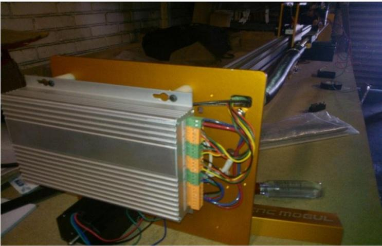
Figura 7.2. La fuente de poder con un voltaje de 110v con sus entradas y salidas de voltaje que alimentan con el voltaje necesario para los motores.
