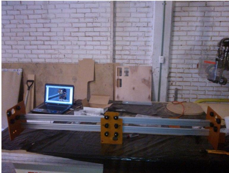
Luego del ensamble de la estructura principal de la máquina, mejor conocida como puente, debido a que es la parte que hace el movimiento sobre la mesa de trabajo, contiene los motores que dan el movimiento a los ejes, incluyendo ya sea el spindle, maneral para plasma, navaja tangencial, etc. Estos elementos serán adaptados por cada cliente según sus necesidades.
