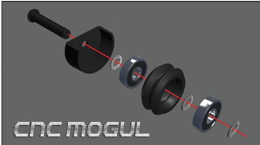
Figura 1.1. Aquí se muestra el ensamble realizado de uno de los rodamientos así se procedió con cada uno hasta obtener el número de rodamientos obtenidos.
