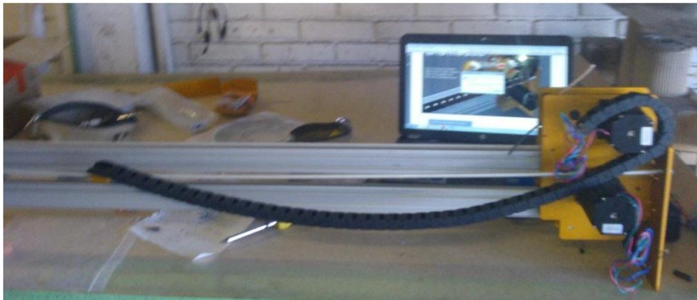
El cable utilizado fueron dos calibres el primero para el de alimentación que es de un calibre 18 y tiene un amperaje máximo a distancias cortas de 16  $\Omega$  lo cual es suficiente para resistir el amperaje de entrada, además el cableado utilizado para los motores y conexiones en general de la maquina se utilizó un cable de calibre 24 este tiene una capacidad máxima de 3.5 $\Omega$  a distancias cortas el cual es suficiente para el circuito de salida de la fuente de poder.
