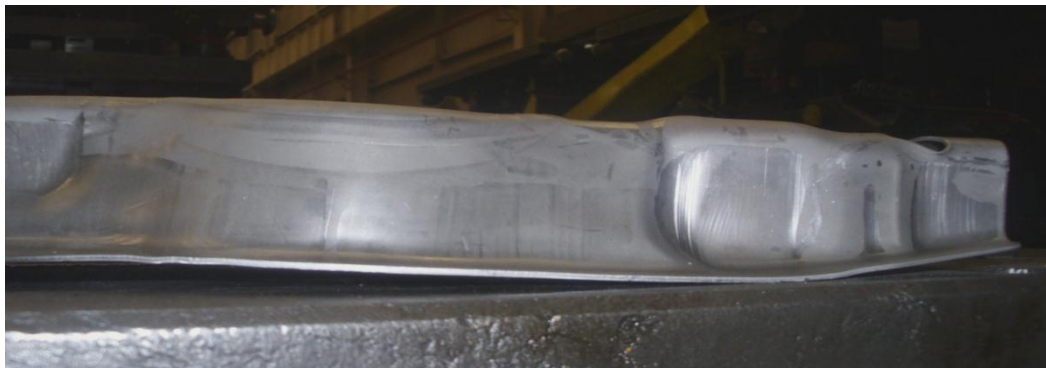
Figura 6: 5QM 505 371 sin defecto de arruga en proceso D5
