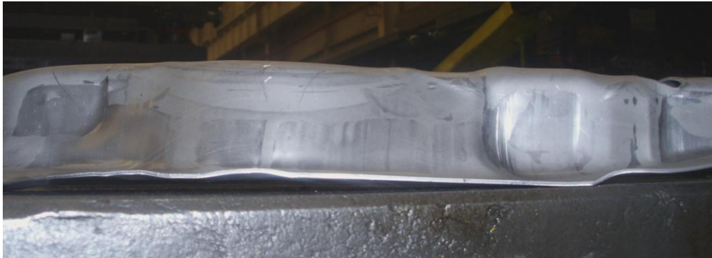
Figura 5: 5QM 505 371 con defecto de arruga en proceso D5
